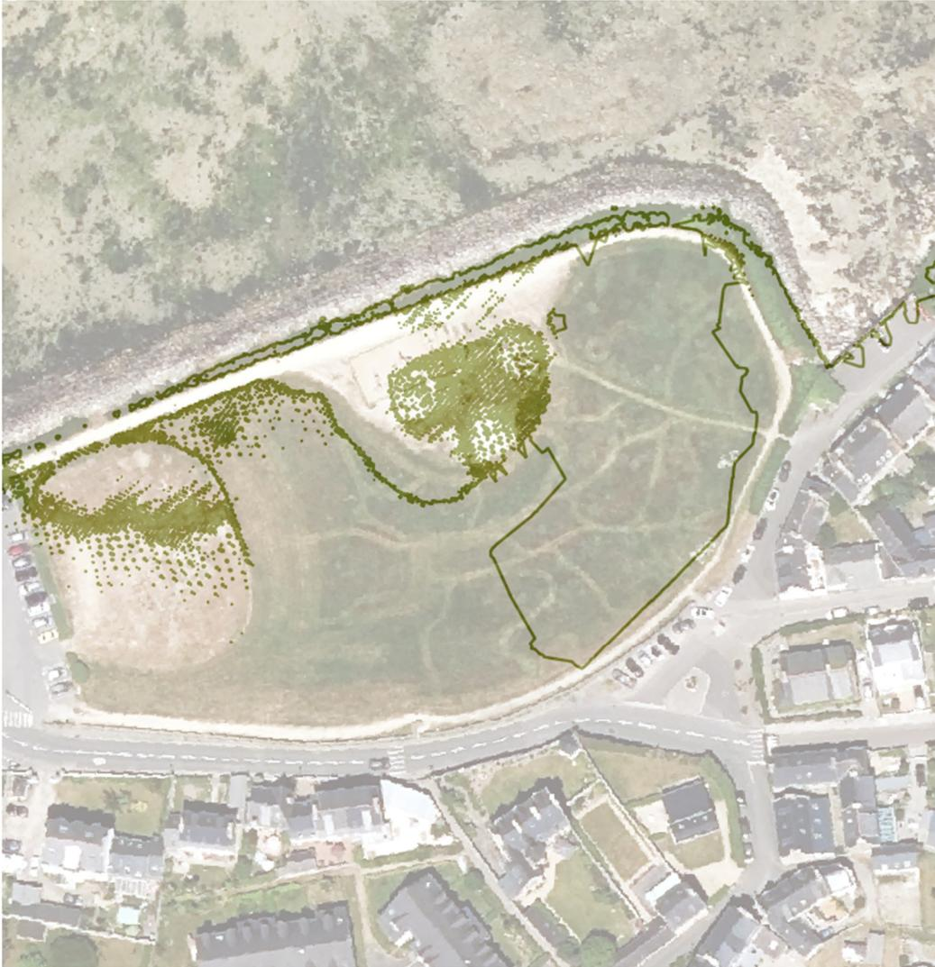
Figure 29. Spatialisation de l'impact d'un évènement de submersion à 5.8564 m NFG : période de retour de 1 ans avec scénario de réchauffement climatique "maximum".
