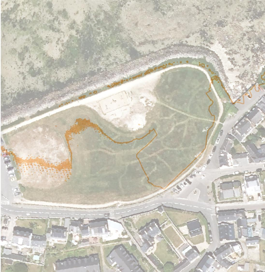
Figure 32. Spatialisation de l'impact d'un évènement de submersion à 6.0629 m NFG : période de retour de 10 ans avec scénario de réchauffement climatique "maximum".
