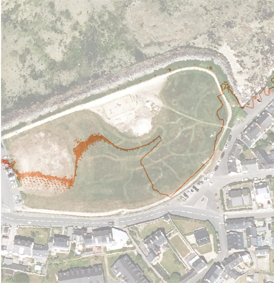
Figure 3 Spatialisation de l'impact d'un évènement de submersion à 6.2054 m NFG : période de retour de 50 ans avec scénario de réchauffement climatique "maximum".
