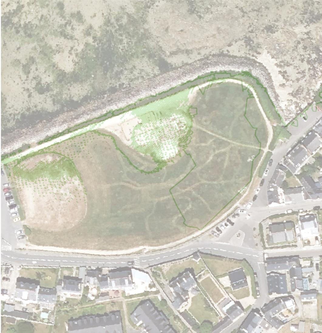
Figure 27. Spatialisation de l'impact d'un évènement de submersion à 5.7966 m NFG : période de retour de 100 ans avec scénario de réchauffement climatique "minimum".
