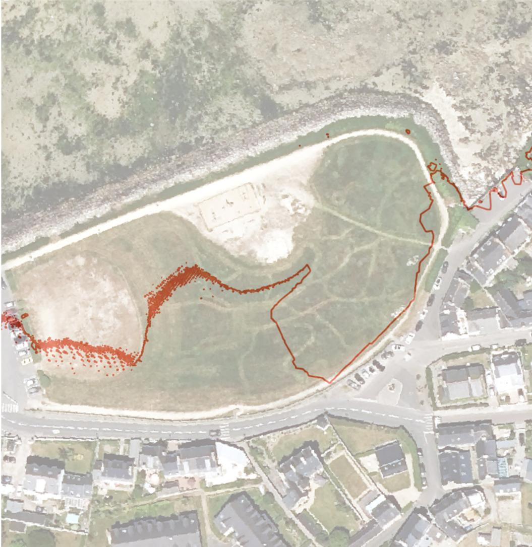
Figure 34. Spatialisation de l'impact d'un évènement de submersion à 6.2666 m NFG : période de retour de 100 ans avec scénario de réchauffement climatique "maximum".
